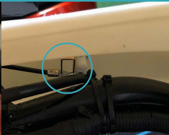
**5.** Une fois la serrure positionnée, replacer le câble de selle dans le crochet de la nouvelle serrure.
