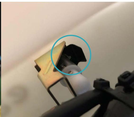
**6.** Pour maintenir correctement la serrure dans votre carénage, l'agrafe noire doit passer dans le dernier cran de la serrure. Sans cela, votre serrure aura du jeu. N'hésitez pas à vérifier et à replacer l'agrafe jusqu'à l'installer correctement.
